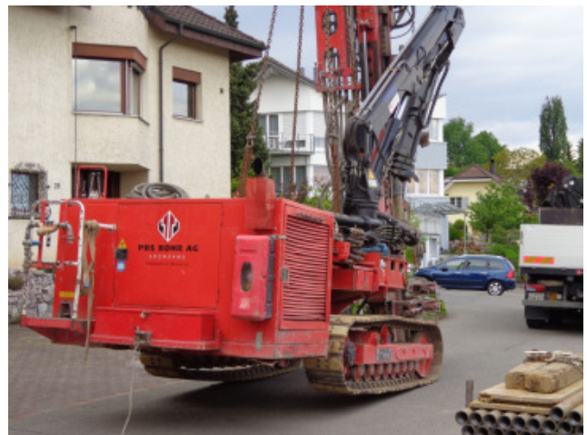
An Ketten wird das Bohrgerät an den Kran gehängt, und gehoben.
